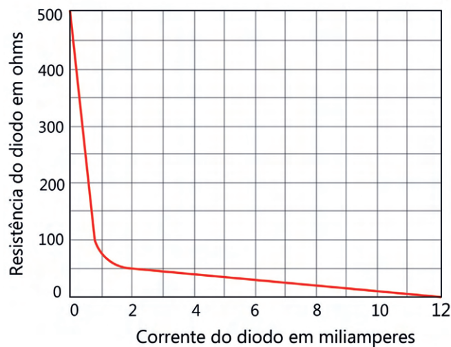
17.8: Característica Resistência x Corrente
