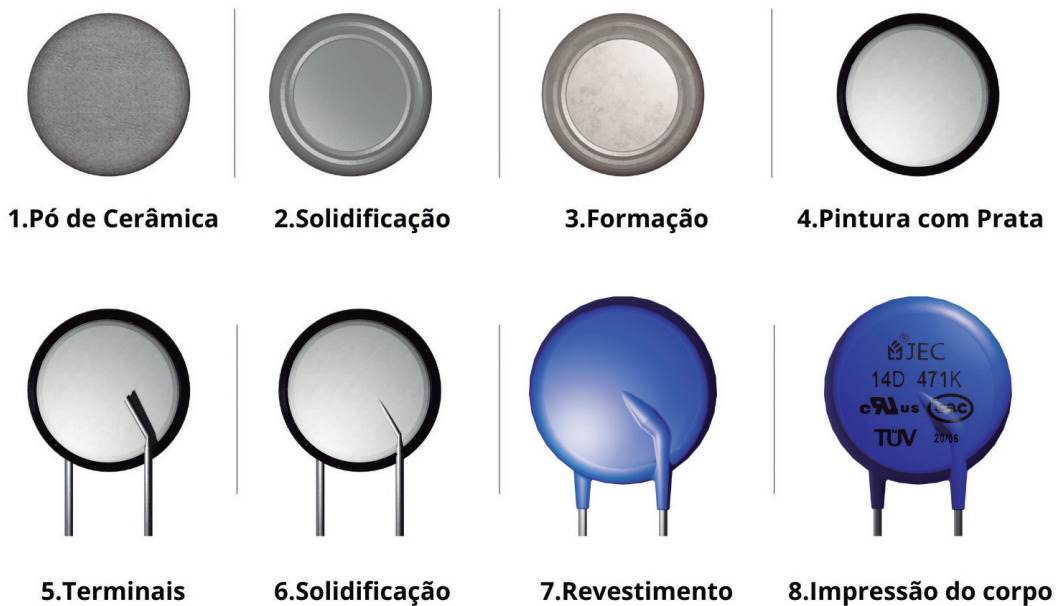
Figura 1.26 Fabricação de Varistores (clique para ver a animação)
