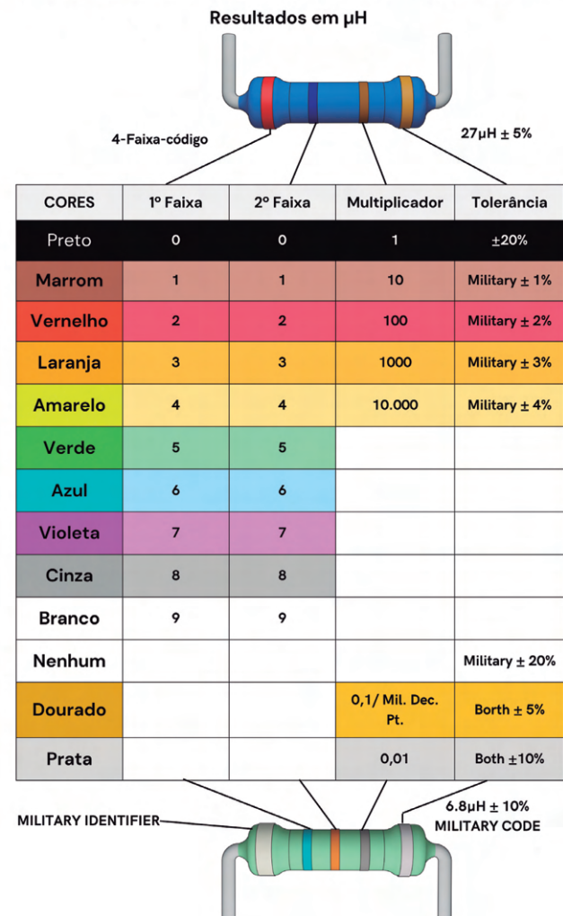
Figura 1.17: Código de Cores para Indutores
