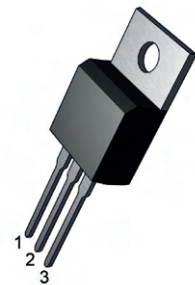
Figura 10.9: Pinagem do LM337 (clique para ver a animação)
