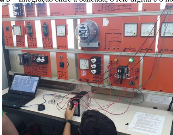
Figura 3 – Integração entre a bancada, o relé digital e o notebook.
