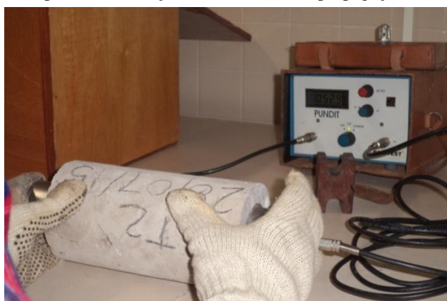
Figura 18 - Ensaio para determinação da velocidade de propagação da onda ultrassônica
