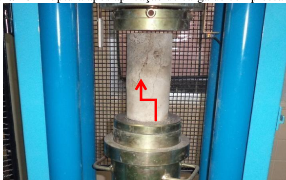
Figura 16 - Ruptura após aplicação de carga de compressão axial
