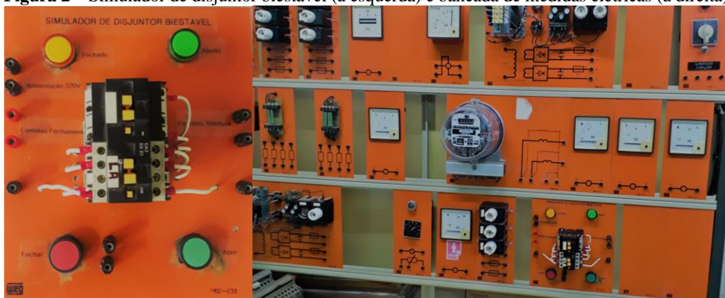
Figura 2 – Simulador de disjuntor biestável (à esquerda) e bancada de medidas elétricas (à direita).
