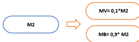
Figura 05: Representação das correntes de entrada e saída para as etapas de cozimento e resfriamento
