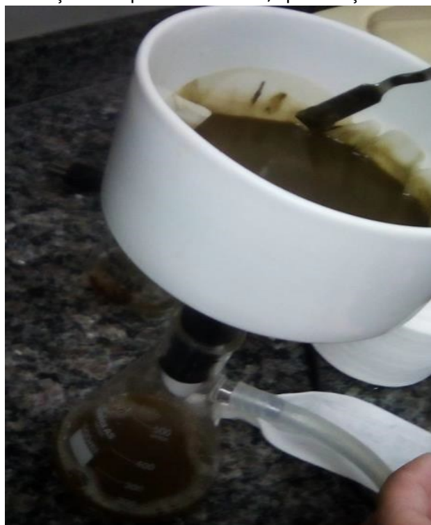
Figura 03: esquema de filtração do líquido metabólico, após eluição do fermentado com tampão.
